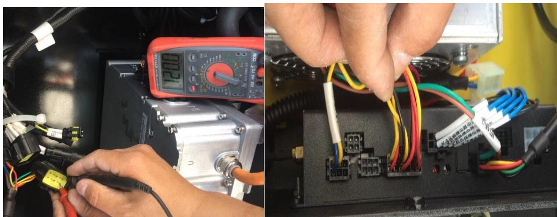
采取措施：因此只能将 BMS 电池管理系统主控模块 120 欧姆电阻通讯去掉，将 BMS 电池管理系统主控模块的 CAN 跳线剪掉，后测量 BMS 电池管理系统主控模块 CAN H 和 CAN L 之间的通讯为无穷大，最后测量高压控制系统中 CAN H 和 CAN L 之间的通讯电阻就正常了，线号 33CAN- H 和线号 34CAN- L 之间电阻为 60 欧姆。如图，检测正常。CAN H 和 CAN L 之间的的通讯电压也是正常，线号 33CAN- H 的电压为 2.3v 和
