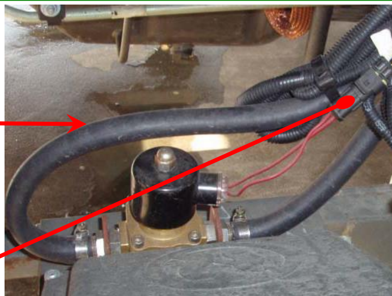
引脚定义（电磁阀电阻： <200\Omega ）
