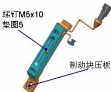
图 4-6：制动块压板总成
