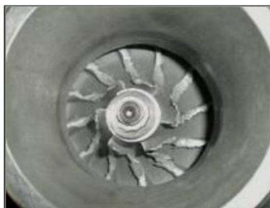
被硬物损坏的叶轮
