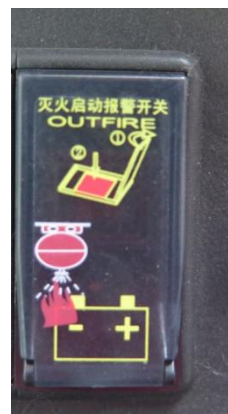
灭火器手动控制开关照片
