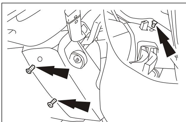
(2) 拆下转向柱的上下护板
