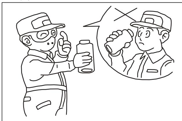
1. 制冷剂凝固点低，挥发性强，因此为了防止与皮肤接触时引起的冻疮、失明等现象，须使用手套及眼镜。
