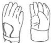
1.拆解和安装高压零部件<br>2.保护绝缘手套       |
