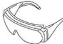
拆解和安装高压零部件<br>检修电线时防止火光飞溅,保护眼睛 |
