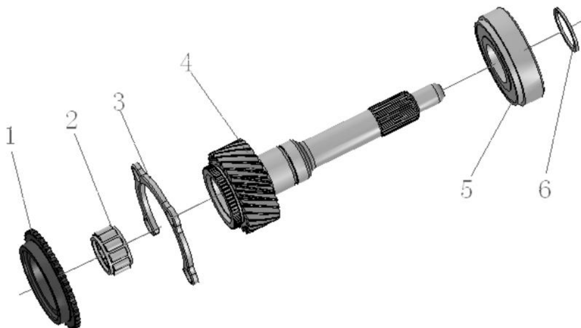
图 2. 变速器总成分解
