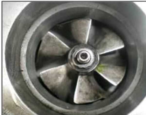
叶轮刮壳磨损严重
