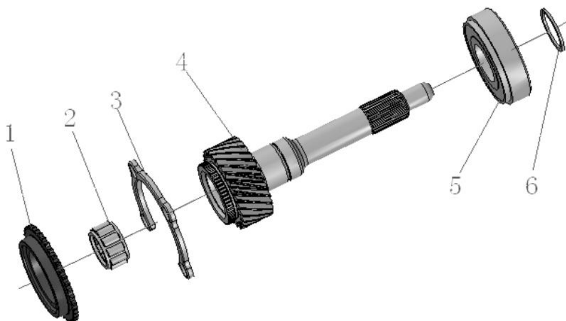
图 2. 变速器总成分解
